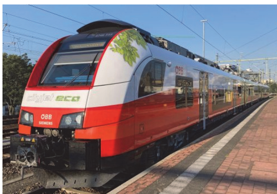
Рис. 1. Поезд Desiro Main Line Eco с питанием от аккумуляторных батарей
